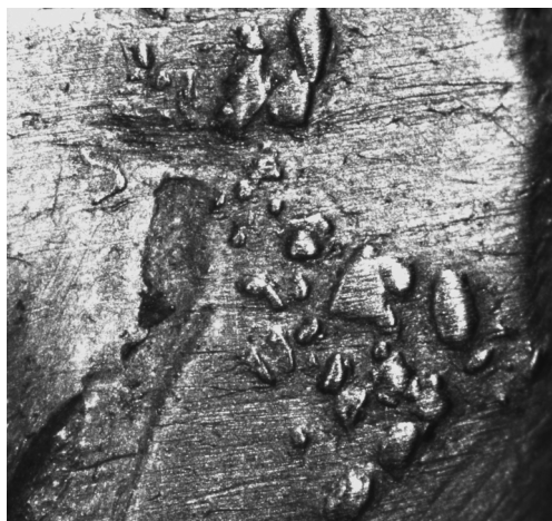
Рис. 9. Скопление включений металлов платиновой группы в золоте меча (фото М.С. Шемаханской)
